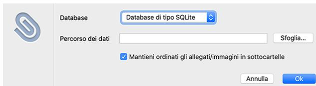
Abbinato ad ogni percorso esiste l'opzione Mantieni Ordinati gli Allegati/Immagini in Sottocartelle che, se attivata, crea delle sottocartelle del tipo "000", "001" dove verranno memorizzati al massimo da 1.000 a 3.000 file per cartella, per evitare di creare decine di migliaia di file nello stesso folder.
